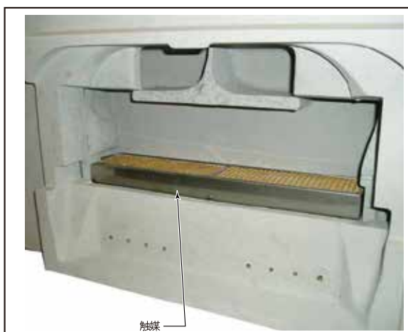
図 11 触媒の取り外し
