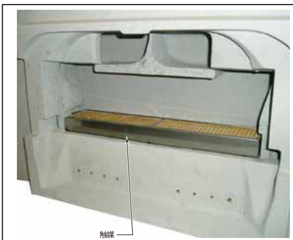
図 11 触媒の取り外し
